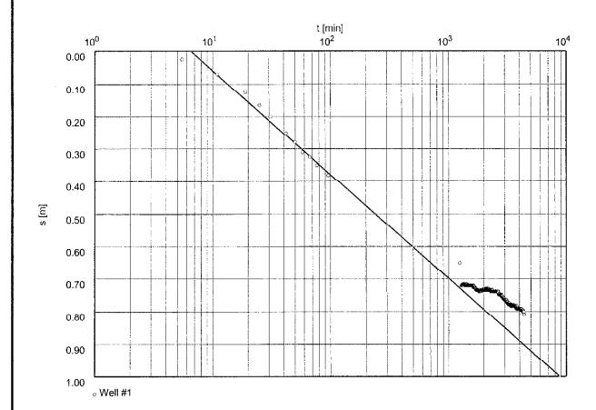
Transmissivity [m²/min]: 1.15 x 10<sup>-1</sup>
