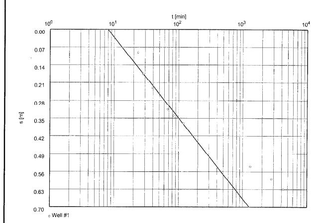
Transmissivity [m²/min]: 1.12 x 10<sup>-1</sup>
