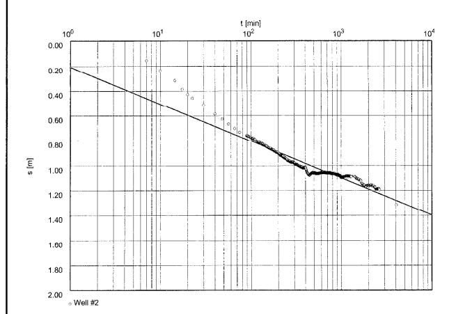
Transmissivity [m²/min]: 1.24 x 10<sup>-1</sup>
